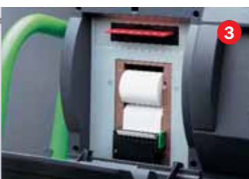
Snelle protocolprinter (< 5 s) en eenvoudige update via diskette
